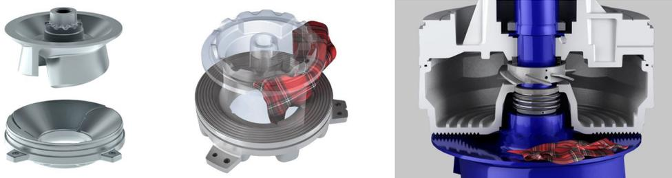
La estructura en espiral del fondo de la cámara de aceite expulsa las posibles fibras que eventualmente pudieran introducirse entre la parte superior del impulsor y el cuerpo de la bomba.
