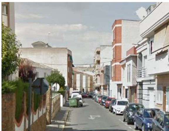
Ilustración 87. Excesiva proporción de la calzada que no permite cumplir los mínimos de accesibilidad.
