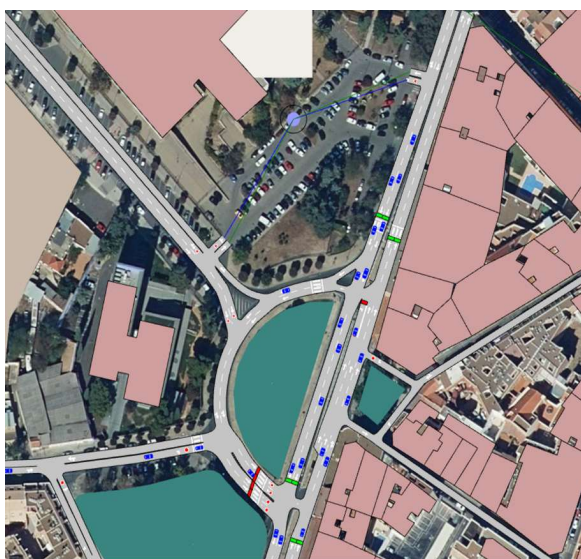
Ilustración 152. Grafo utilizado para hacer el estudio de microsimulación.
