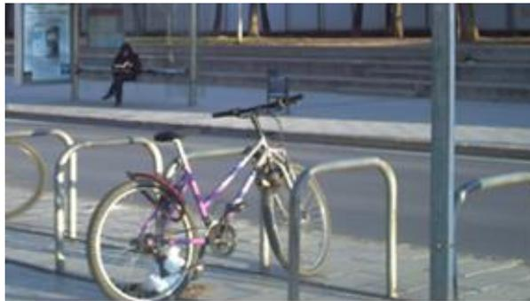
**Figura 82: Modelos de aparcabicis en forma de U invertida o Universal. Fuente: DOYMO.**
