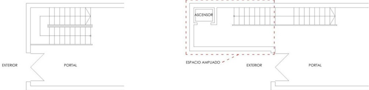
GRÁFICO 6.-INSTALACIÓN DE ASCENSOR EXTERIOR MODIFICANDO LA GEOMETRÍA DE LA ESCALERA. ESTADO ORIGINAL ESTADO REFORMADO
