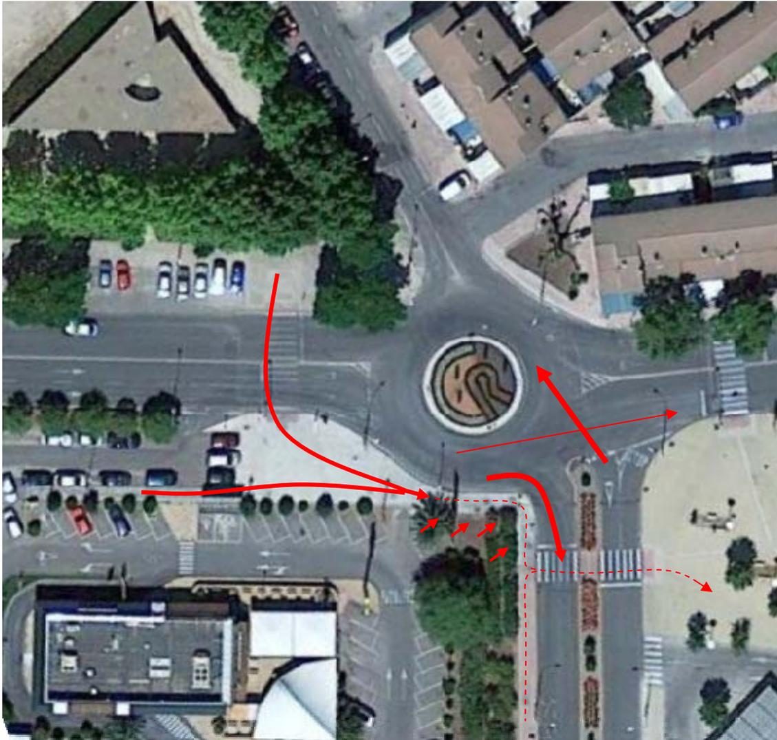
Otras zonas de aparcamiento, como la coincidente con el Parque del Pilar, resultan inadecuadas al estar dispuesta en batería en una vía principal y con dificultad de visión para la maniobra. Además, la profundidad excesiva de las plazas de aparcamiento (más de 6 m) hace que se desaproveche el espacio que puede ser usado por los peatones o para completar la alineación del arbolado de la Avenida.
